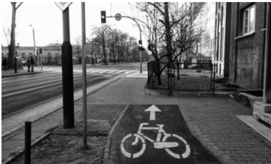
Znaczenie ciągłości i spójności infrastruktury można odczuć w miejscach takich jak skrzyżowanie ulic Polnej i Bukowskiej w Poznaniu, gdzie droga rowerowa nagle się kończy. Sytuacje takie wynikają z niewielkiej ilości wolnego miejsca na istniejących ulicach, struktury własności gruntów i błędów popełnianych przez projektantów, fot. M. Czepkiewicz
